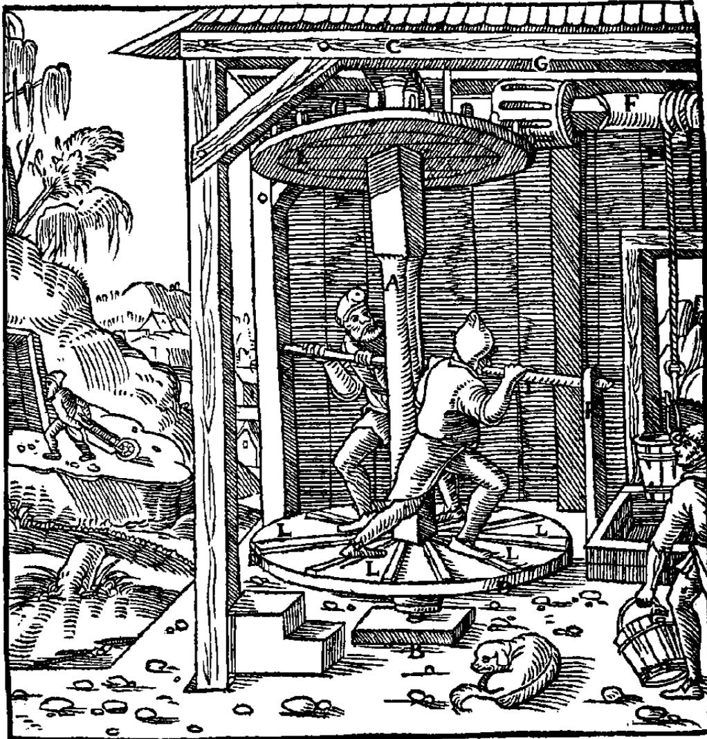
A : Grand axe vertical    B : Bloc de bois    C : Jante    D : Roue    E : Roue dentée
